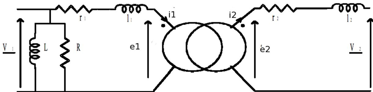
Les tensions composées nominales de ce transformateur sont :  $U_{1n} = 400 \text{ V}$ ,  $U_{2n} = 24\sqrt{3} \text{ V}$  et le courant secondaire nominal en ligne  $I_{2n}$  est égal à 50 A.
